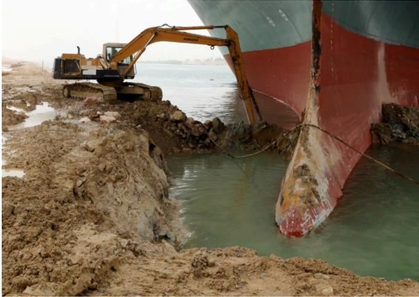
Une pelleteuse tente de dégager l'avant du bateau. (© Suez Canal Press Service / Sputnik via AFP). L'avant du porte-conteneurs était coincé dans le sable. À terre, **des pelleteuses ont creusé le canal** pour libérer le navire. Sur l'eau, des remorqueurs, **de petits bateaux très puissants, tiraient le navire pour le faire bouger.** Le lundi 29 mars, le porte-conteneurs a enfin été remis droit et le canal a été rouvert ? la circulation.
